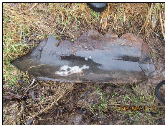
Foto 20 – Detail potrubí na hlavním toku (azbestocement)
